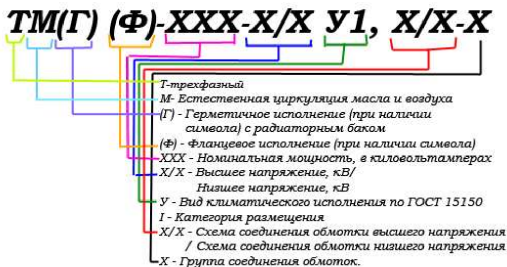
Рисунок 1 - Структура условного обозначения трансформаторов ТМ и ТМГ.
